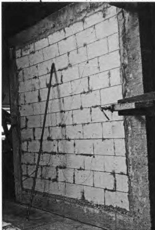
Вид образца № 2 после испытания
